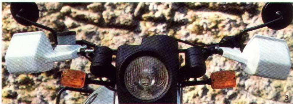
(3) La protezione per le mani BMW evita le lesioni e ripara dall'aria durante la marcia.
