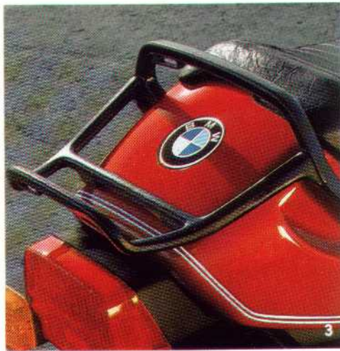
(2, 3) Sul portapacchi possono essere fissati in modo sicuro la borsa portatute, il topcase e altri bagagli.
