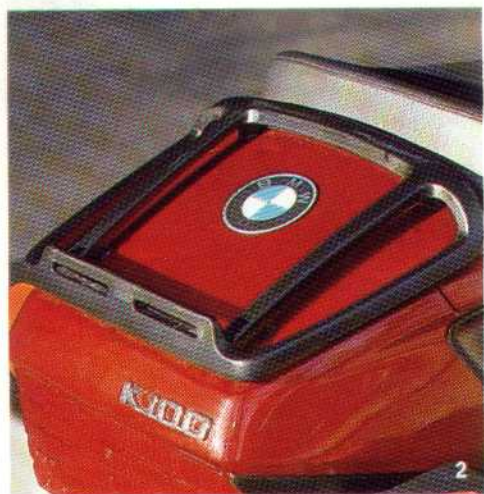
(1) Il topcase BMW ha una capacità di 20 l. La serratura è incorporata nello schienale.
