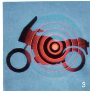
3 Un antifurto intelligente: l'impianto d'allarme elettronico BMW entra in funzione in caso di modifica dell'inclinazione laterale, forti scosse ed interruzione del cavo dell'avvisatore acustico di serie.
