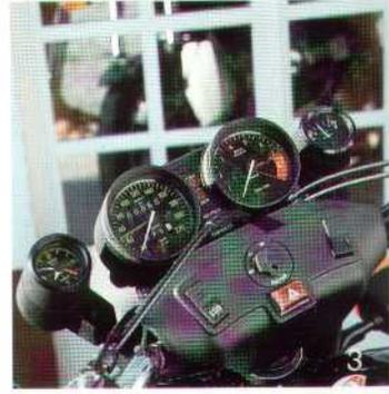
3 Un po' di tensione ci vuole: il voltmetro BMW indica lo stato di carica della batteria. Per l'ora esatta ci sono l'orologio digitale (modelli K) o al quarzo (Boxer).
