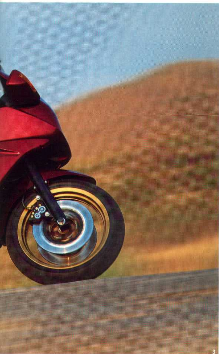
3. La BMW K 1100 RS, legittima erede della moto gran turismo più apprezzata degli ultimi anni. La carenatura ottimizzata ed il propulsore 1100 di nuova concezione a 4 cilindri e 16 valvole consentono prestazioni ancora più brillanti. Una serie di migliorie nei particolari, inoltre, fa sì che non si avverta alcuna vibrazione del motore.
