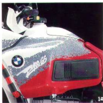
1. Il tratto più tipico della BMW R 100 GS PD: il serbatoio. La sua capacità di 35 l. (benzina senza piombo a 91 ottani RON) consente un'autonomia di 500 km. Nella parte superiore è ricavato un ripostiglio da 5 l. con serratura.
