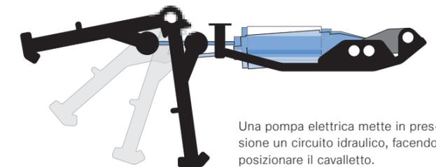
Una pompa elettrica mette in pressione un circuito idraulico, facendo posizionare il cavalletto.
