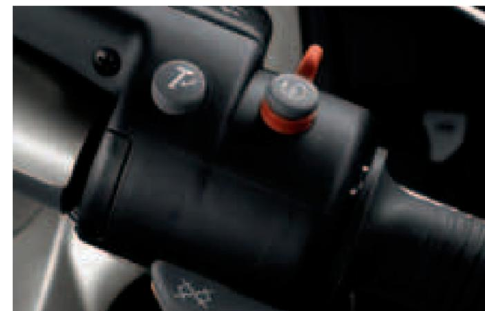
387 chilogrammi si spostano senza difficoltà premendo un tasto. Il cavalletto centrale elettroidraulico si aziona sul lato destro del manubrio.
