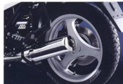
Ansichten erstklassiger Fahrwerkstechnik: der patentierte BMW Paralever, das Hinterradfederbein mit progressiver Kennung und die 3-Speichen-Felgen mit Niederquerschnittsreifen.
