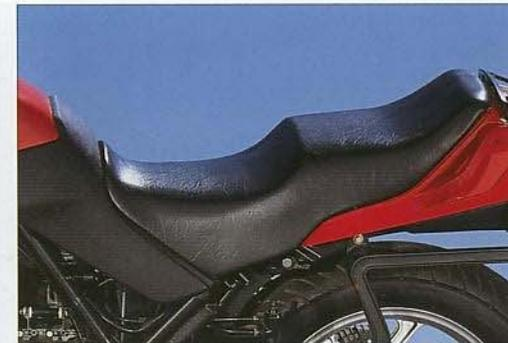
Aufsteigen mit Spaß: die niedrige Sitzbank (760 mm) der K75 ermöglicht auch für Fahrer von kleinerer Statur jederzeit sichere Fahrzeugbeherrschung bei souveräner, entspannter Fahrweise.
