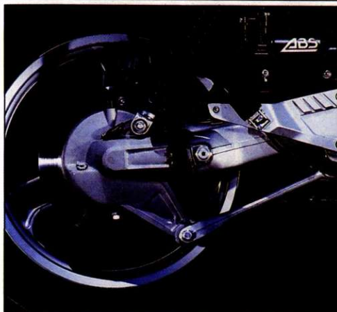
Zentrale Verbesserung der Fahrwerkskomponenten ist die Übertragung der aus der K1 und aus der GS-Baureihe bekannten Paralevertechnologie auf die K100RS. Die Vorteile in Kürze: wesentlich geringere Lastwechselreaktion, geringere Neigung zu Bremsstempeln, besserer Federungskomfort, erhöhtes Beschleunigungsvermögen durch deutlich verbesserte Traktion, stabileres Fahrverhalten in Schräglage bei Bodenebenheiten.
