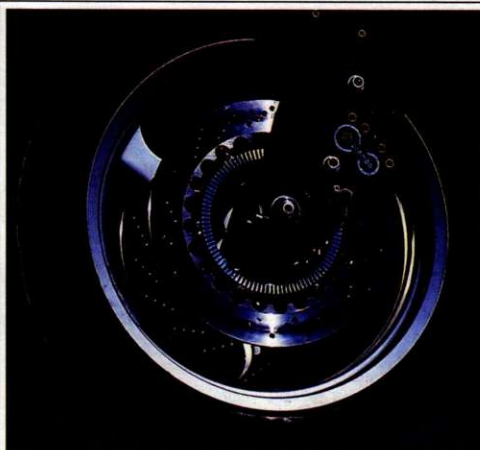
Die neue Marzocchi-Teleskopgabel mit besonders niedrigen Losbrechkräften, progressiver Federkennung und wegabhängiger Dämpfung trägt eine Bremsanlage, die dem Leistungspotential der K100RS mehr als angemessen ist: vorn mit schwimmend gelagerten Bremsscheiben (Durchmesser 305 mm), 4-Kolben-Bremssätteln mit Schrägablaufausgleich und optimierter Bremsarmatur zur Verbesserung des Druckpunktverhaltens.
