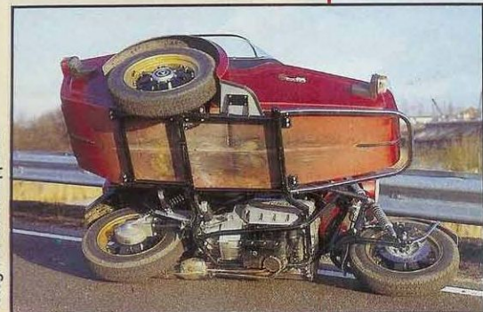
Van onderen is het nieuwe frame goed te zien. De verchromde stang dient als bumper.
