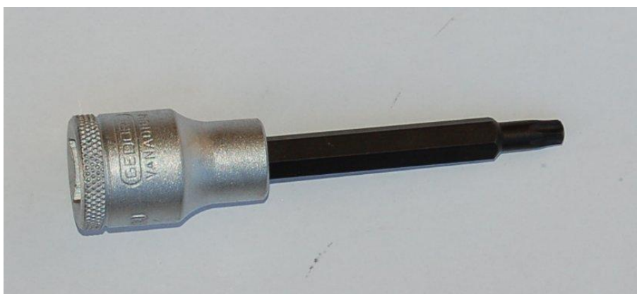
Un utensile professionale per le viti Torx con attacco da ½ pollice.
