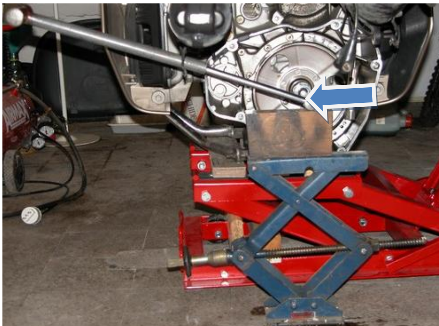
Come allentare il dado frizione senza pistola ad aria compressa.
