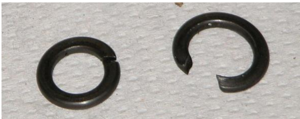
Sostituire le rondelle con altre nuove
