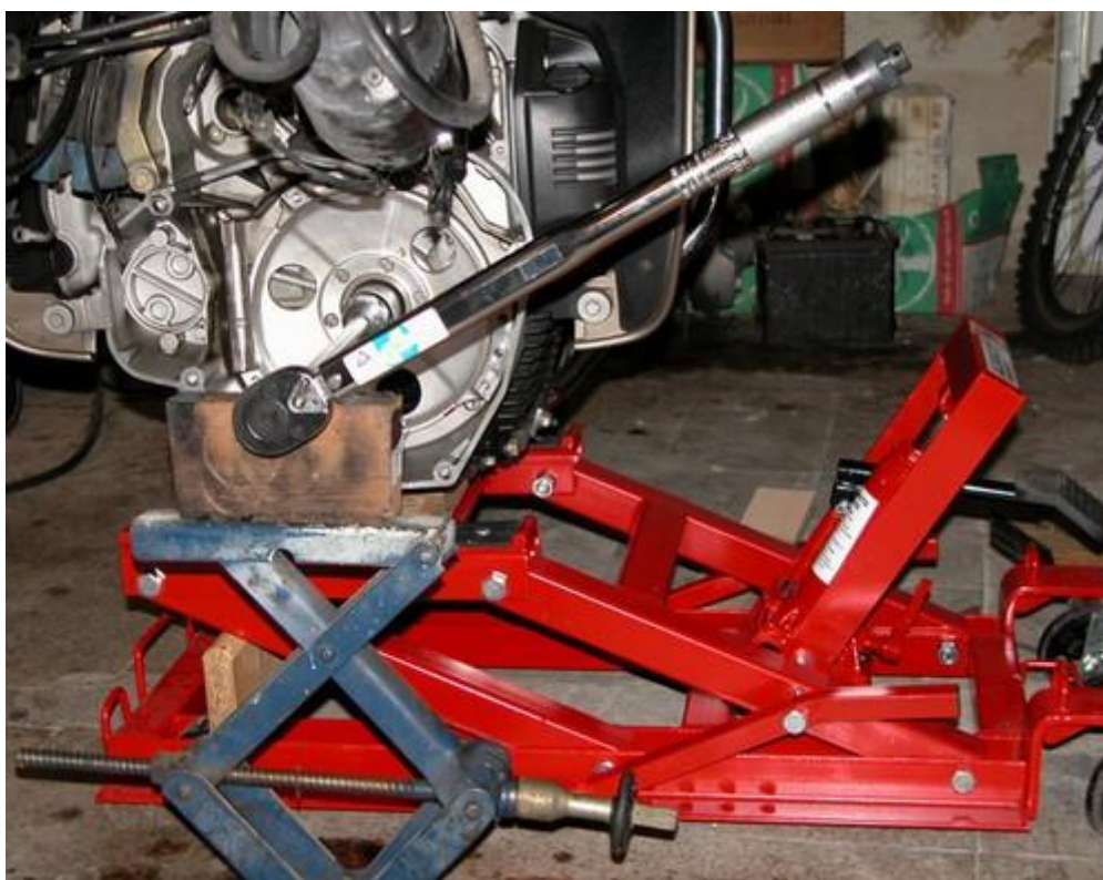
Il serraggio del dado frizione
