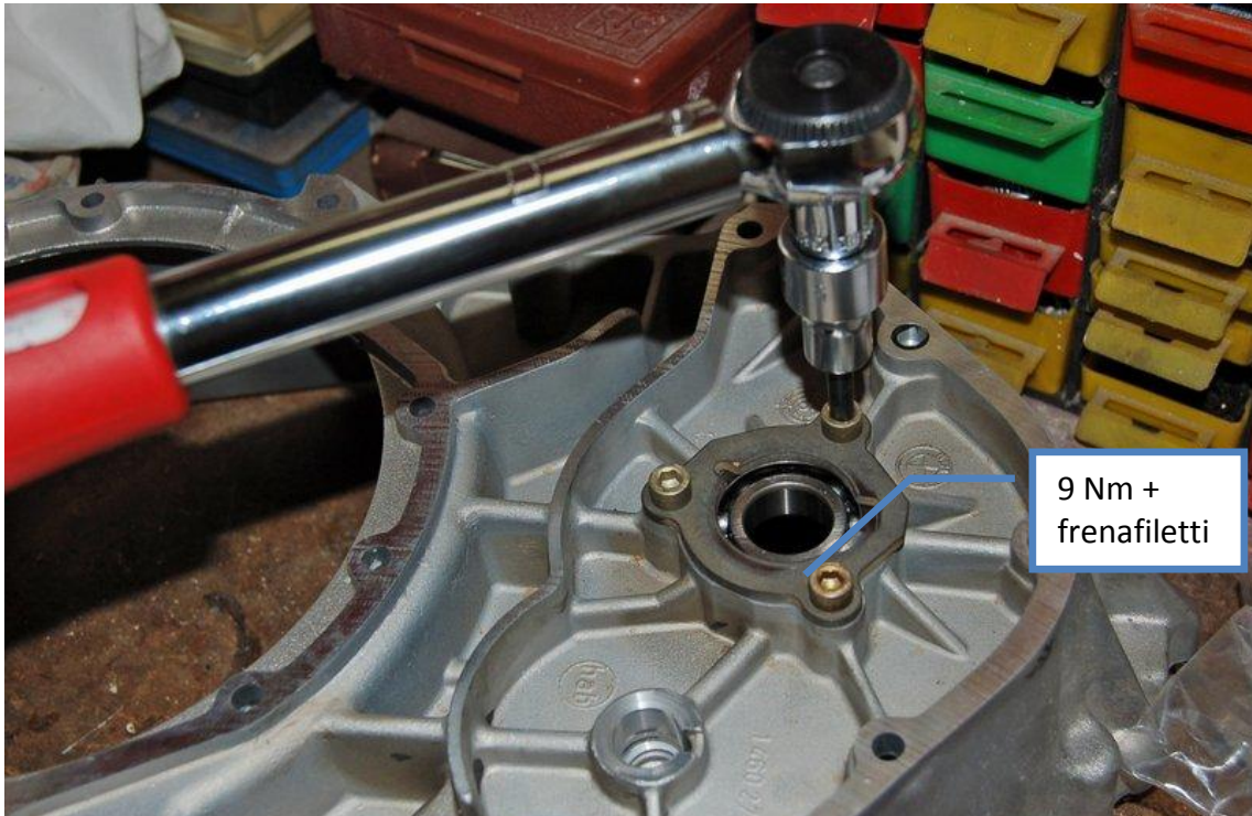
Rimontare la flangia e le tre viti di fermo, anche in questo caso a 9 Nm e con una goccia di frenafite.
