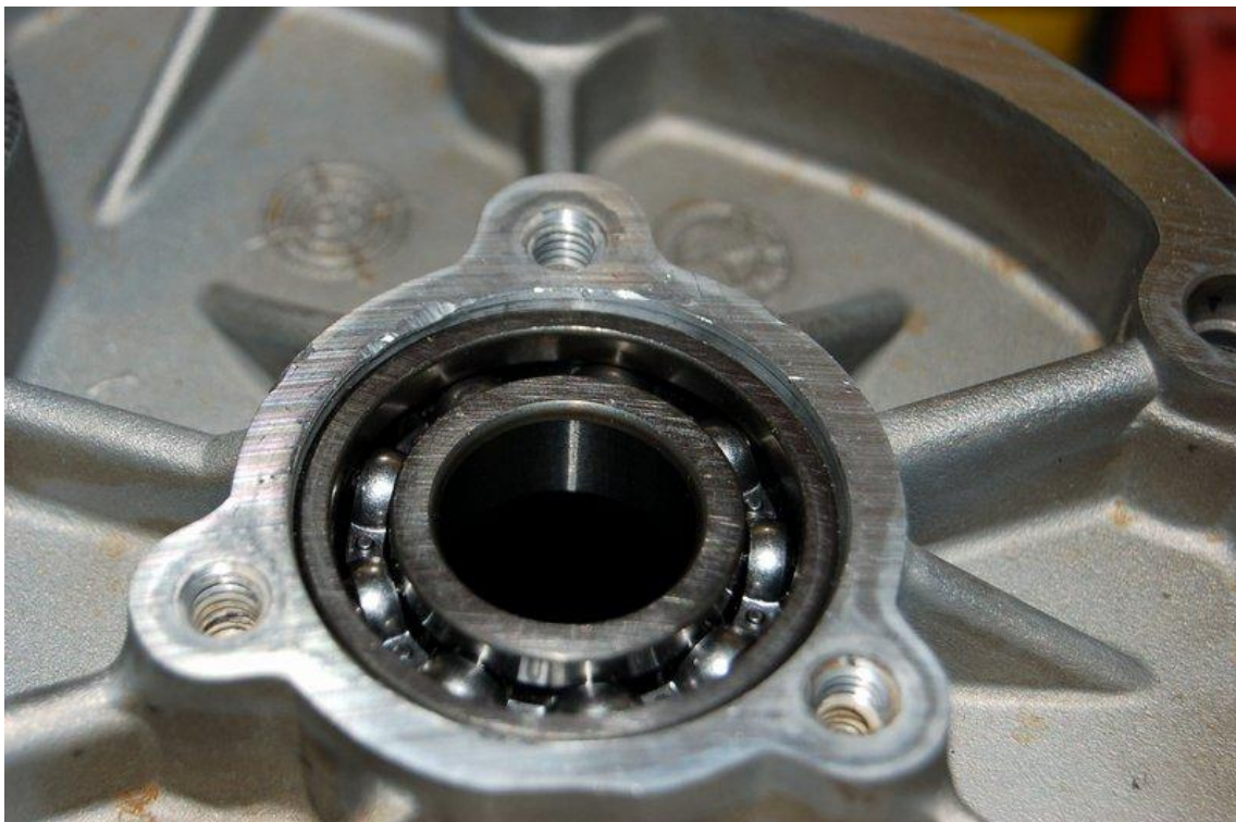
Il cuscinetto inserito. Deve entrare fino alla battuta nel seeger. Notare il piccolo spazio per la molla a tazza.
