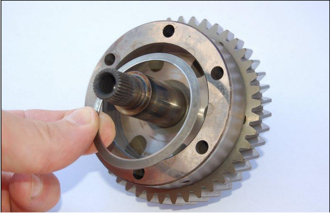
Inserire la molla a tazza con la parte convessa in alto (verso la zigrinatura).
