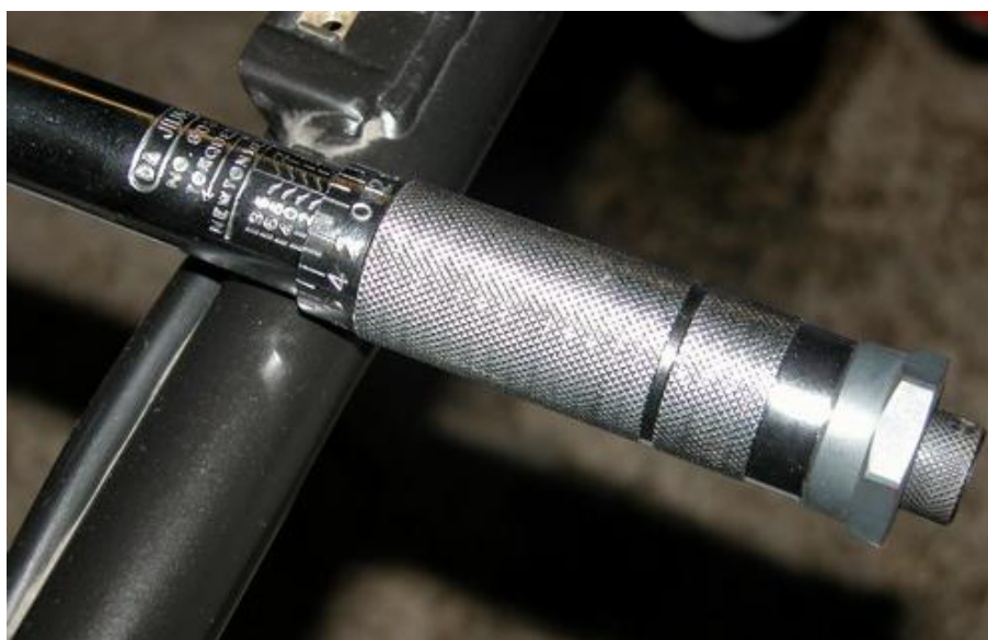
Regolazione chiave dinamometrica
