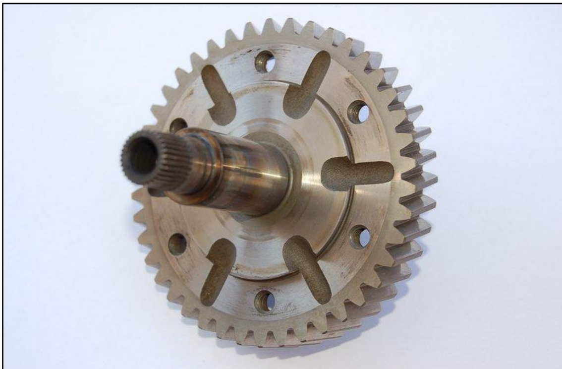
Appoggiare l'albero sul piano di lavoro con la parte zigrinata in alto.
