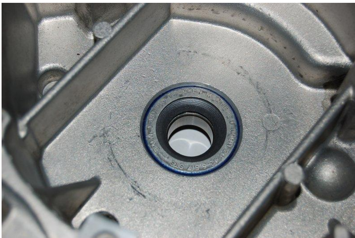
Inserire il paraolio come mostrato, con molta attenzione, fino alla battuta nel seeger.
