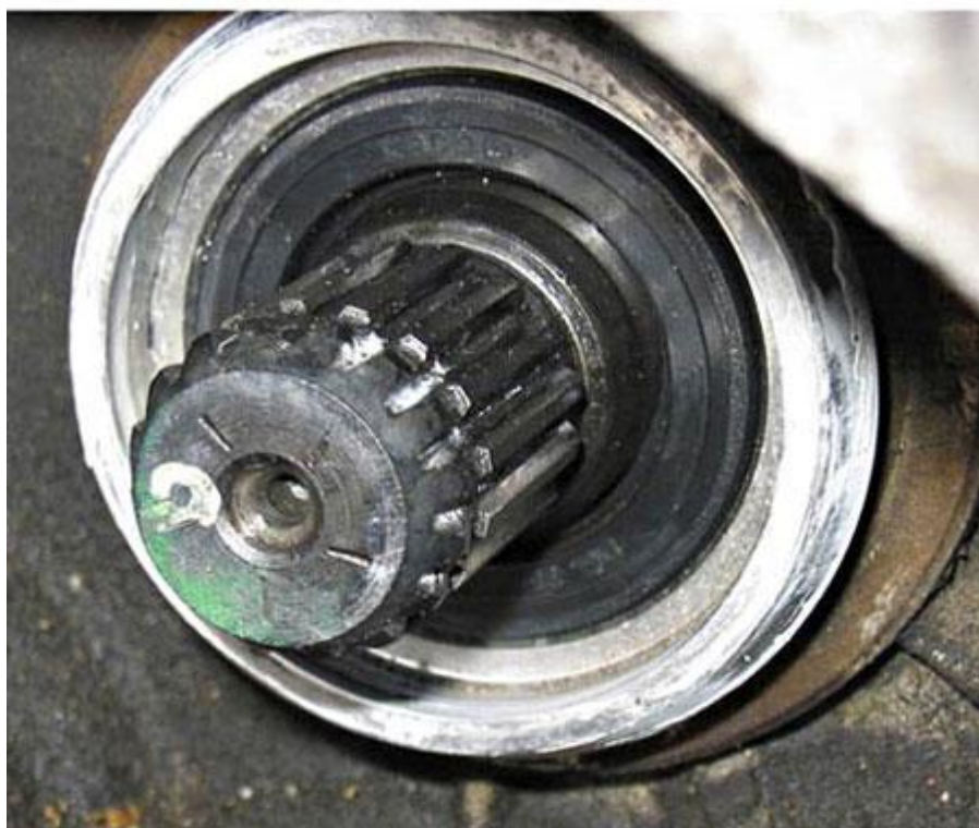
Millerighe lato motore – si noti la sede del circlip
