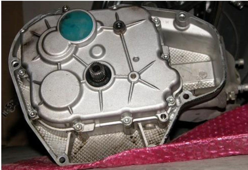
Il cambio smontato – visibile il paraolio – cambiarlo in ogni caso
