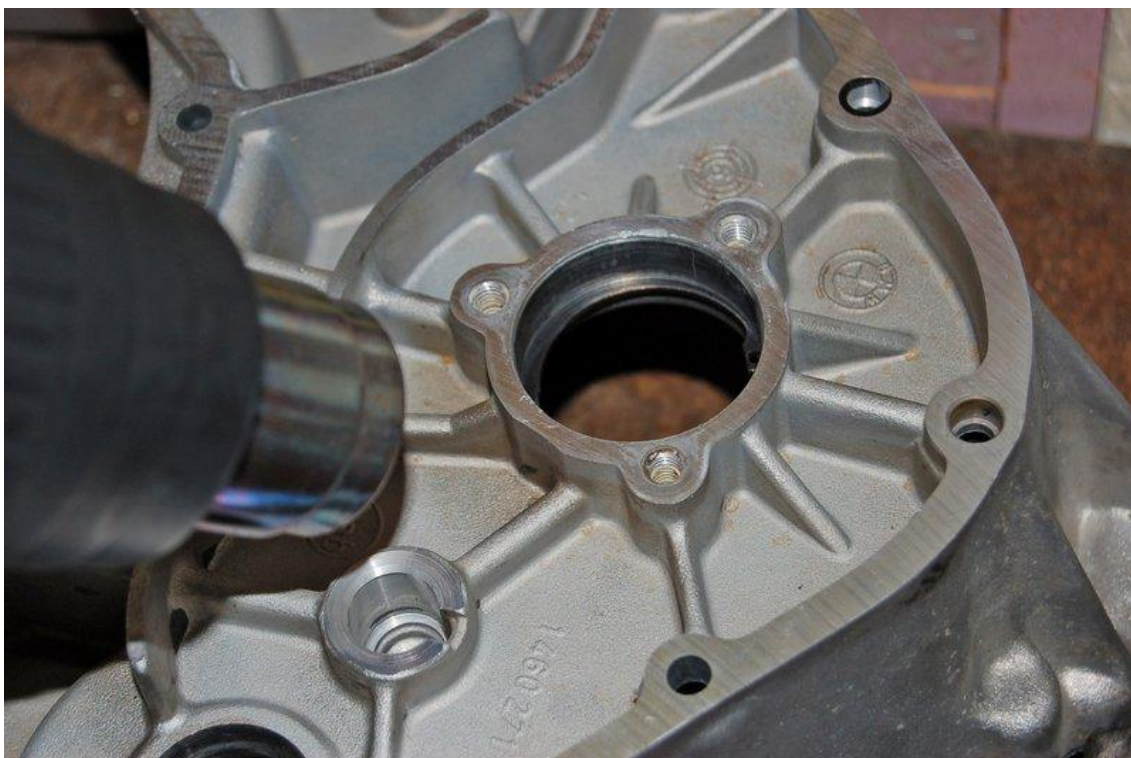
Riscaldamento della sede del cuscinetto per facilitare l'inserimento del nuovo pezzo.
