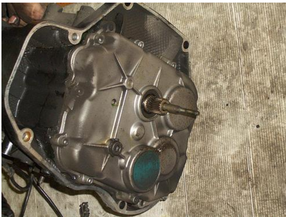
Il cambio smontato – visibile l'astina della frizione
