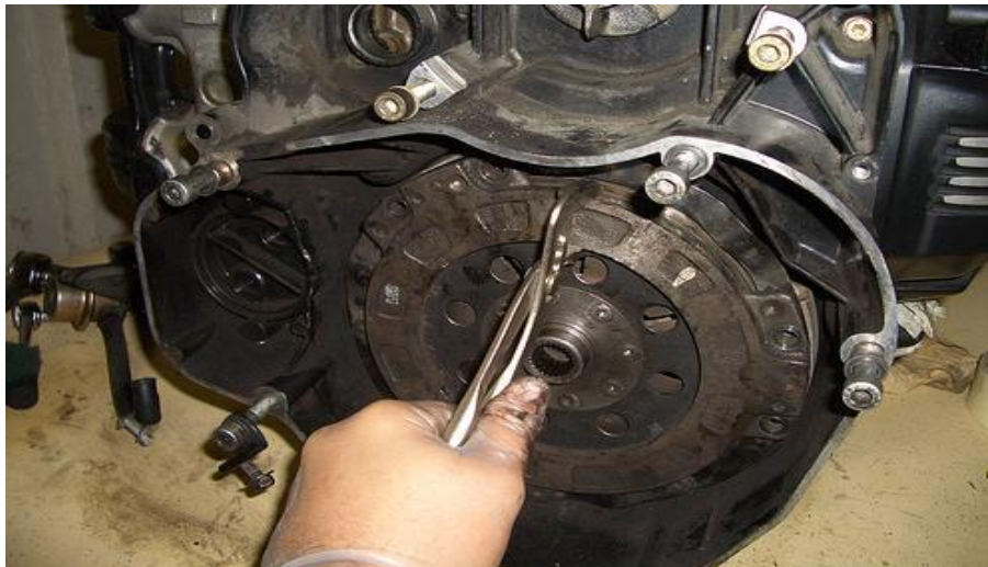
Smontaggio della frizione
