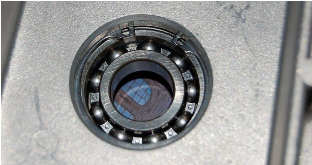
Il cuscinetto, visto dal lato dell'alternatore.
